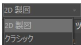
画面左上の【ワークスペース】から【2D 製図】を選択するとリボンが表示されます。【クラシック】を選択するとメニューバーとツールバーが表示され、リボンは表示されなくなります。
