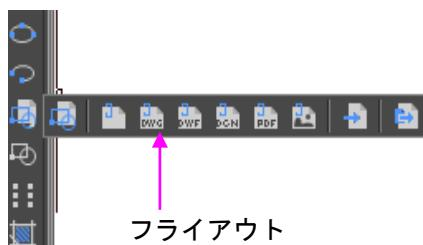
右下隅に黒い三角がついているツールの上でマウスの左ボタンを押し続けるとフライアウトが表示されます。ツールバーには、メニューバーの下やウィンドウ枠に埋め込まれたドッキングツールバーと独立したウィンドウとして配置できる浮動ツールバーがあります。
