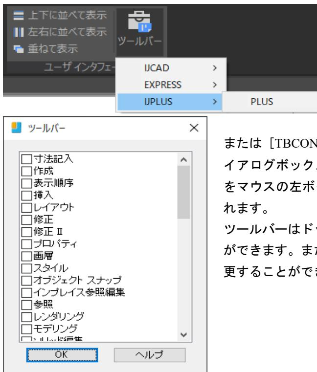
または [TBCONFIG] とコマンドウィンドウに入力し、ダイアログボックスに表示されるツールバー名の先頭の  をマウスの左ボタンでクリックする ✓ 印がチェックされます。
