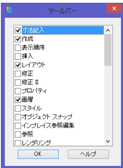
または [TBCONFIG] とコマンドウィンドウに入力し、ダイアログボックスに表示されるツールバー名の先頭の  をマウスの左ボタンでクリックすると  印がチェックされます。
