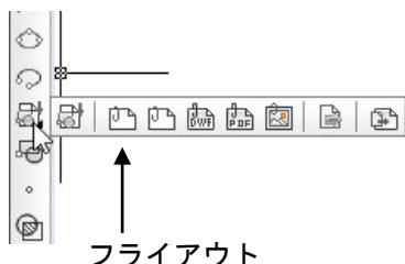
右下隅に黒い三角がついているツールの上でマウスの左ボタンを押し続けるとフライアウトが表示されます。ツールバーには、メニューバーの下やウィンドウ枠に埋め込まれたドッキングツールバーと独立したウィンドウとして配置できる浮動ツールバーがあります。
