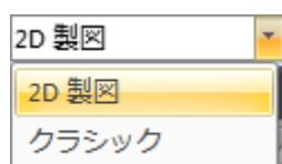
画面左上の [ワークスペース] から [2D 製図] を選択するとリボンが表示されます。[クラシック]を選択するとメニューとツールバーが表示され、リボンは表示されなくなります。
