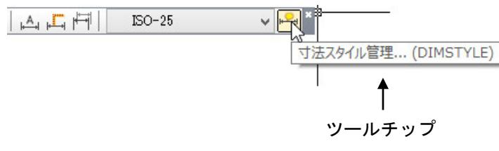
ツールバーにはコマンドを実行するツールボタンが入っています。ツールボタンの上にカーソルを移動すると、カーソルの脇にツールチップが現れ、そのツールの名前を表示します。
