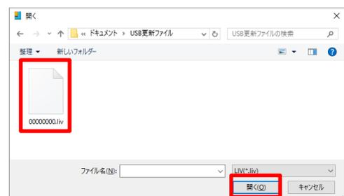
その際 [IJCAD\_UsbUpdater] ダイアログの上部に表示されている 8 桁の数字と、メールにて受け取ったファイルのファイル名が同じであることを確認してください。
